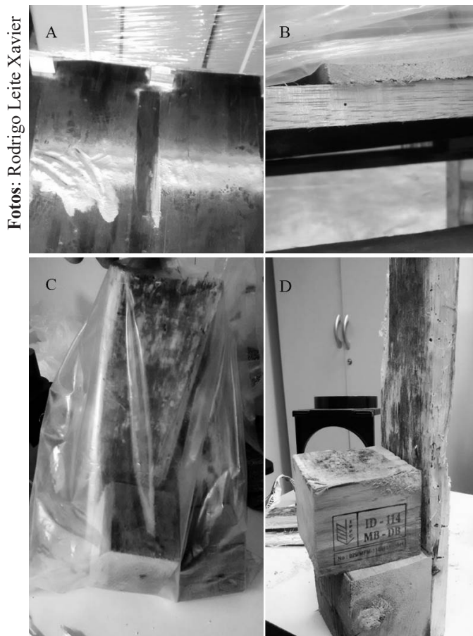
Figura 1. Verificação de resíduos de madeira no interior do contêiner (A), orifício causado por Sinoxylon unidentatum (Coleoptera: Bostrichidae) em palete (B), amostra coletada do palete infestado (C) e amostra do palete em fase de inspeção para exposição dos indivíduos nas galerias (D).
